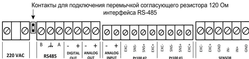
Рисунок Ж.1 – Расположение контактов на клеммной колодке конвертера в отдельном исполнении
